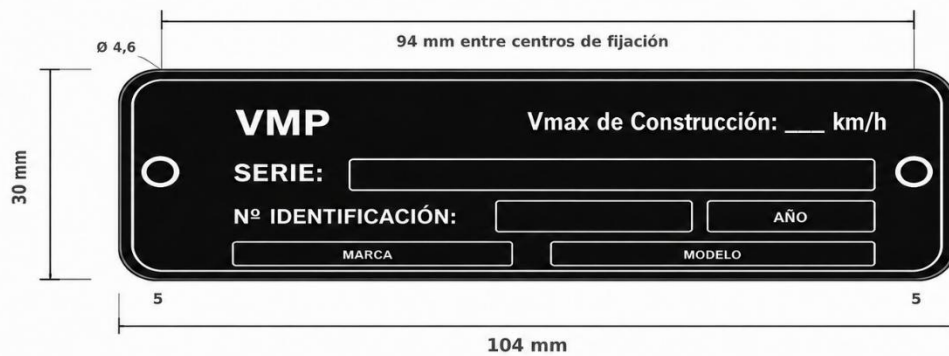
FIGURA 2. DIMENSIONES DE LA LÁMINA DE MARCAJE PARA VMP
